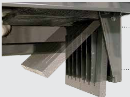
Nettoyage automatique grâce à une grille basculante
